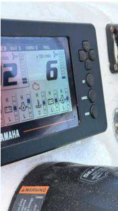
Figura 8. Display Command Link Plus mostrando testigo Check Engine activo (icono motor en rojo) en motor estribor durante la maniobra de retorno.
