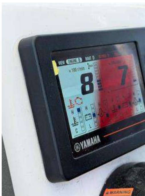
Figura 5. Testigos activos: Check Engine (ícono motor en rojo) y Oil Temp — Motor babor (Engine B) en fondo rojo — condición crítica.
