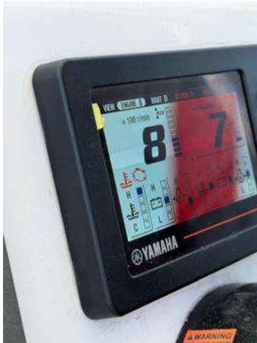
Figura 6. Panel de instrumentos mostrando testigos activos: icono de motor (Check Engine) en rojo e icono de temperatura de aceite (Oil Temp) — motor babor (Engine B) en fondo rojo indicando condición crítica.
