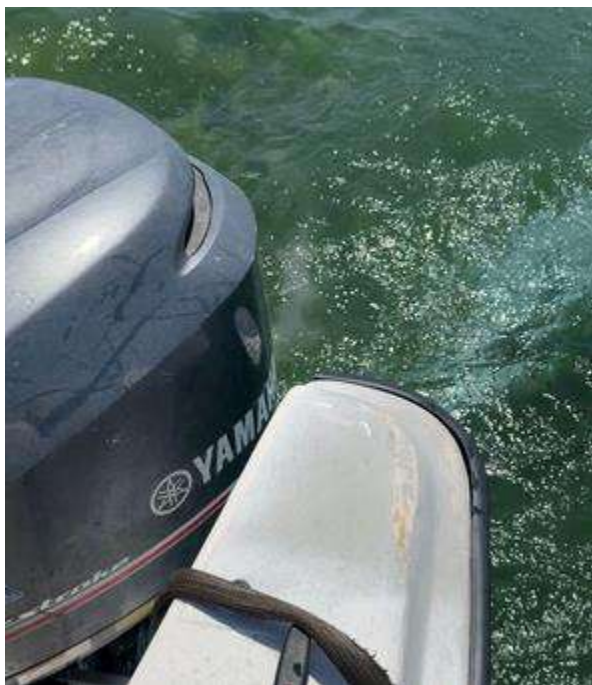
Figura 7. Captura extraída de video (60 fps) evidenciando emisión de humo blanco en el motor babor.
