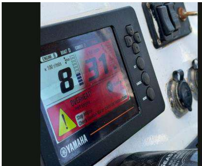
Figura 5. Alarma OVERHEAT — Port Engine activa en el Command Link Plus. RPM motor izquierdo: 800, motor derecho: 3.100.
