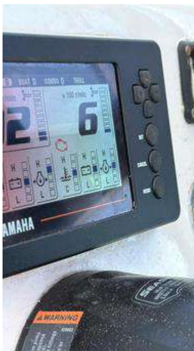
Figura 9. Display Command Link Plus mostrando testigo Check Engine (icono motor en rojo) activo en motor derecho, con iconos de temperatura de agua y temperatura de aceite en estado de monitoreo.
