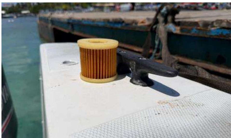
Figura 2. Elemento filtrante del separador de agua/combustible extraído — saturación y coloración anormal.
