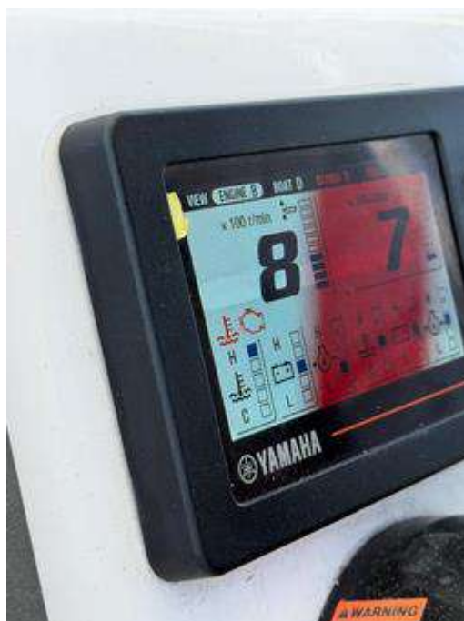
Figura 5. Testigos activos: Check Engine (icono motor en rojo) y Oil Temp — Motor babor (Engine B) en fondo rojo — condición crítica.
