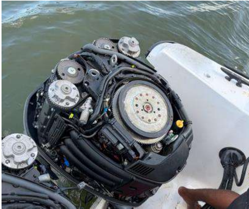
Figura 3. Vista superior del powerhead del motor babor — sistema de distribución DOHC con sprockets de árbol de levas, actuadores VCT y arnés de inyectores visibles.
