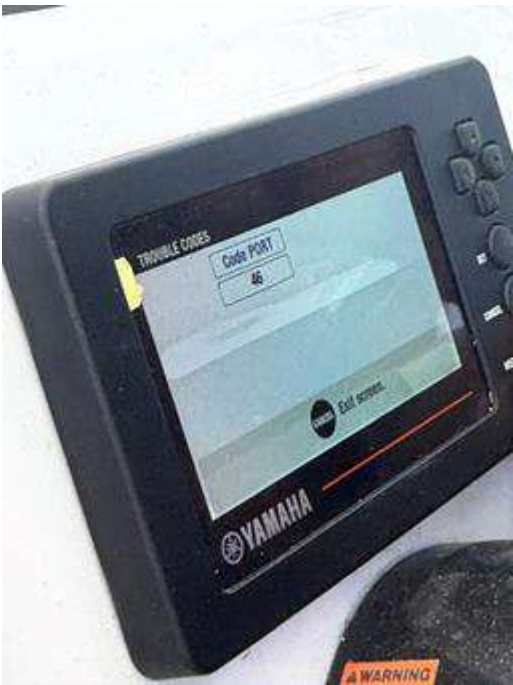
Figura 6. Pantalla TROUBLE CODES del Command Link Plus — Code PORT 46.
